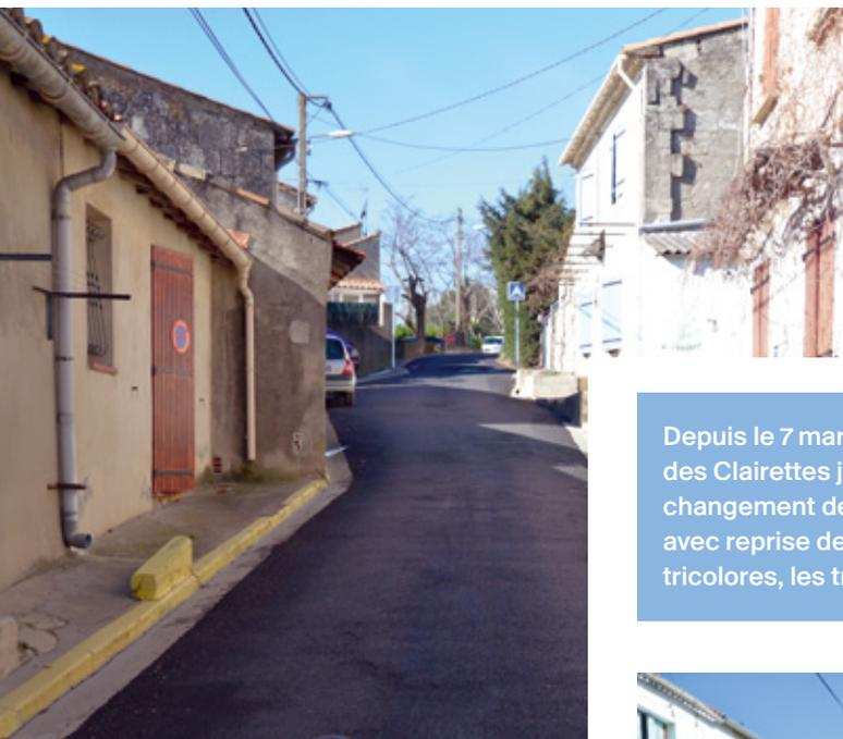
☛ Chemin de la Tour : pose de bordures trottoir en partie haute du chemin pour éviter le ravinement de pierres, qui se retrouvaient le long de la route de Saint-Gilles lors de pluies diluviennes, goudronnage de la chaussée en enrobé, réalisation de système de ralentissements des véhicules 26 000 € TTC.
